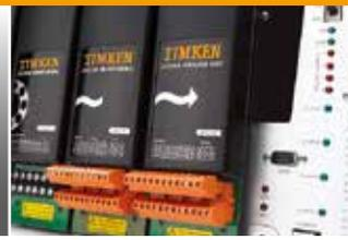
**Timken® 在线智能系统**为重要风机部件提供先进的状态监测。该装置采用冲击脉冲终端，并与 Timken® 服务相结合，为您提供无可匹敌的数据采集与分析能力。
